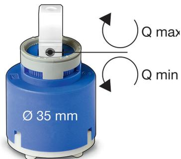
**DE Wassereinsparung bis zu 30 %:** Der maximale Durchfluss lässt sich bei Bedarf durch Drehen der Schraube auf optimale Wassermenge reduzieren.
