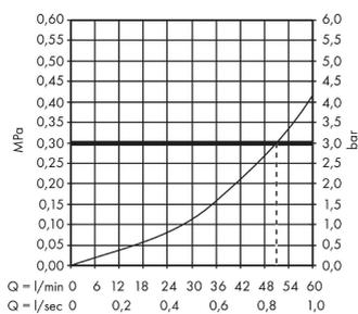
**Grundkörper 52 l/min für Abstellventil Unterputz G 1/2 Spindel**
