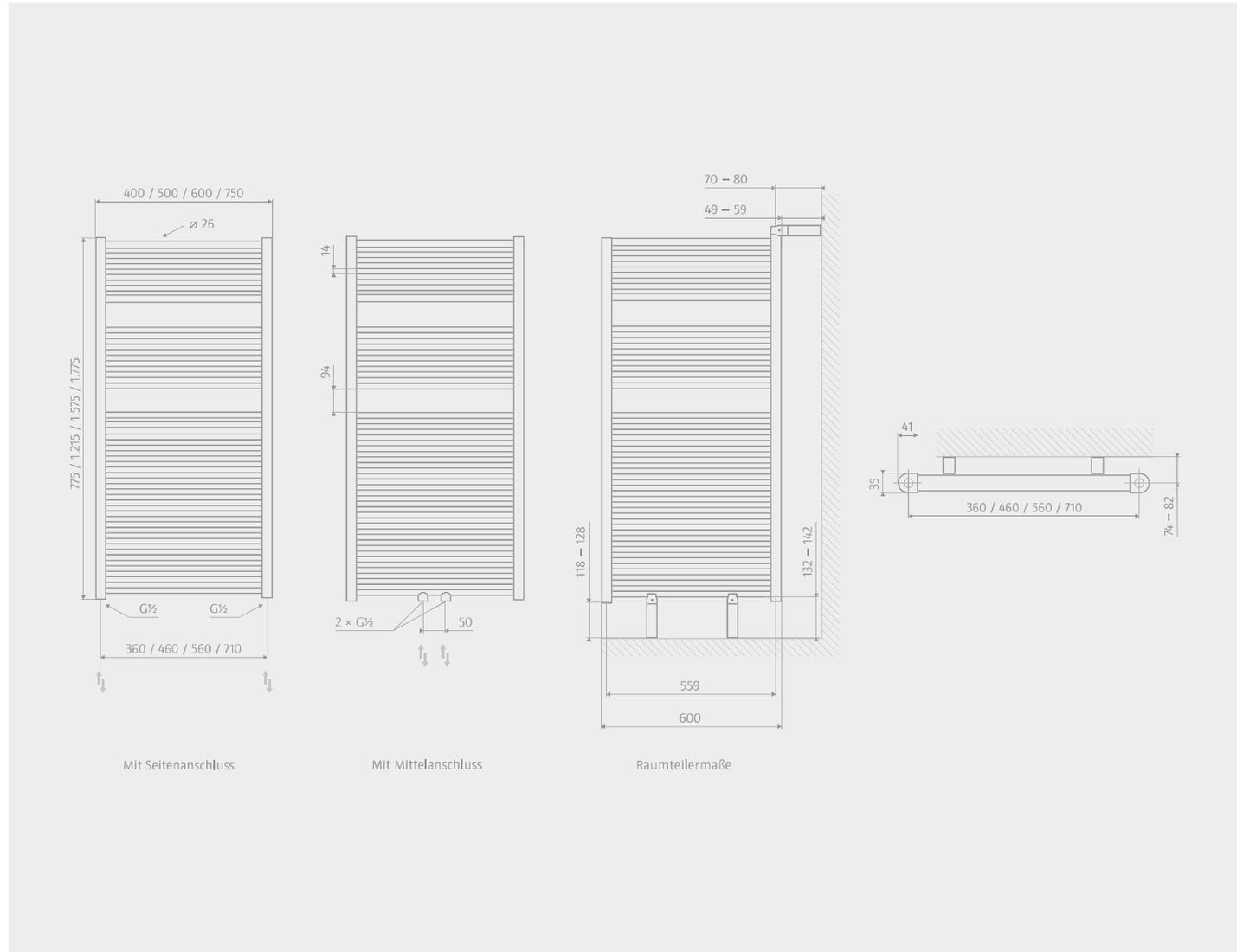
Maximaler Betriebsdruck 10 bar. Konstruktions- und Modelländerungen vorbehalten. Technische Angaben ohne Gewähr. Alle Maßangaben unterliegen einer Toleranz von  $\pm 2$  mm.
