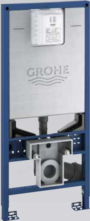
39 865 000 Rapid SLX Element für WC, 1,13 m Bauhöhe inkl. Stromanschluss (Klemmdose) und Wasseranschluss für Dusch-WC, mit 2 Revisionsschächten für kleine und große Betätigungsplatten
