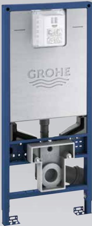
39 865 000 Rapid SLX Element für WC, 1,13 m Bauhöhe inkl. Stromanschluss (Klemmdose) und Wasseranschluss für Dusch-WC, mit 2 Revisionsschächten für kleine und große Betätigungsplatten
