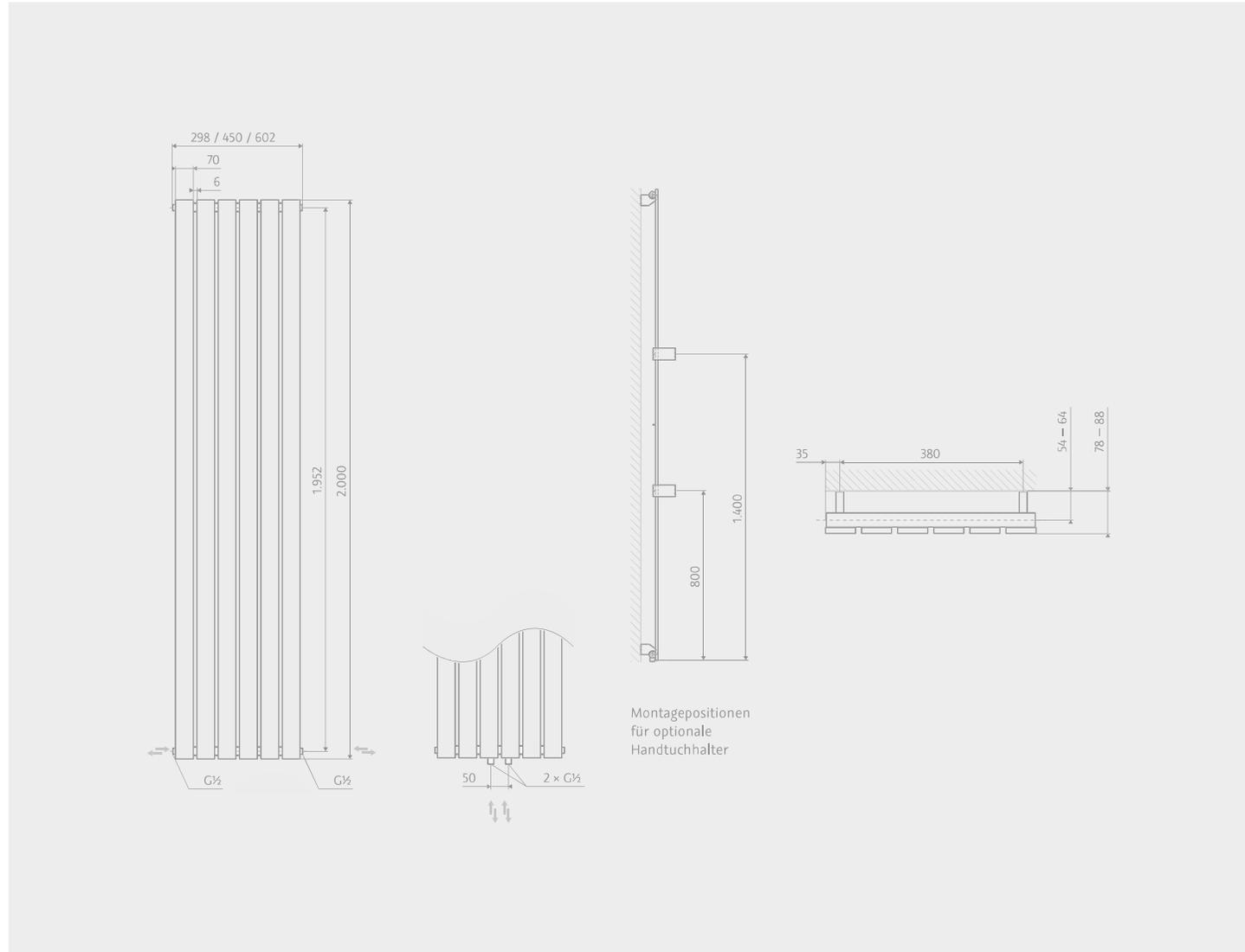
Maximaler Betriebsdruck 5 bar. Konstruktions- und Modelländerungen vorbehalten. Technische Angaben ohne Gewähr. Alle Maßangaben unterliegen einer Toleranz von  $\pm 2$  mm.
