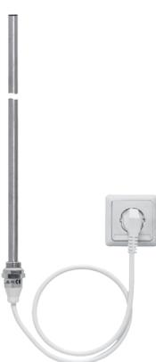
**Elektroheizstab Serie P mit Litze (ZEPELO) oder Stecker (ZEPELS)**, Heizstab mit PTC-Element, Schutzart IP55, Klasse I, Netzspannung 230 V, Tauchkörper aus Edelstahl mit DN 15 (1/2) Anschlussgewinde, O-Ring und Sechskant mit ca. 1,0 m Anschlusskabel mit Litze/Stecker.
