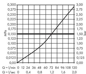
**Grundkörper 130 l/min für Abstellventil Unterputz G 3/4 Spindel**
