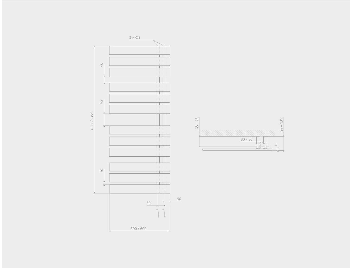
Maximaler Betriebsdruck 4 bar. Konstruktions- und Modelländerungen vorbehalten. Technische Angaben ohne Gewähr. Alle Maßangaben unterliegen einer Toleranz von  $\pm 2$  mm.
