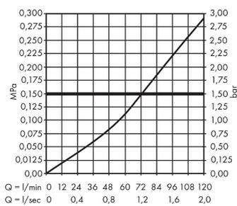
**Grundkörper 130 l/min für Abstellventil Unterputz Spindel G 3/4**
