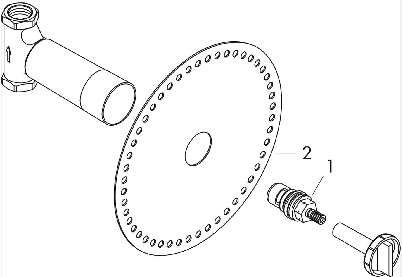
**Grundkörper 130 l/min für Abstellventil Unterputz Spindel G 3/4**
