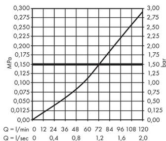
**Grundkörper 130 l/min für Absperrventil Unterputz Spindel**
