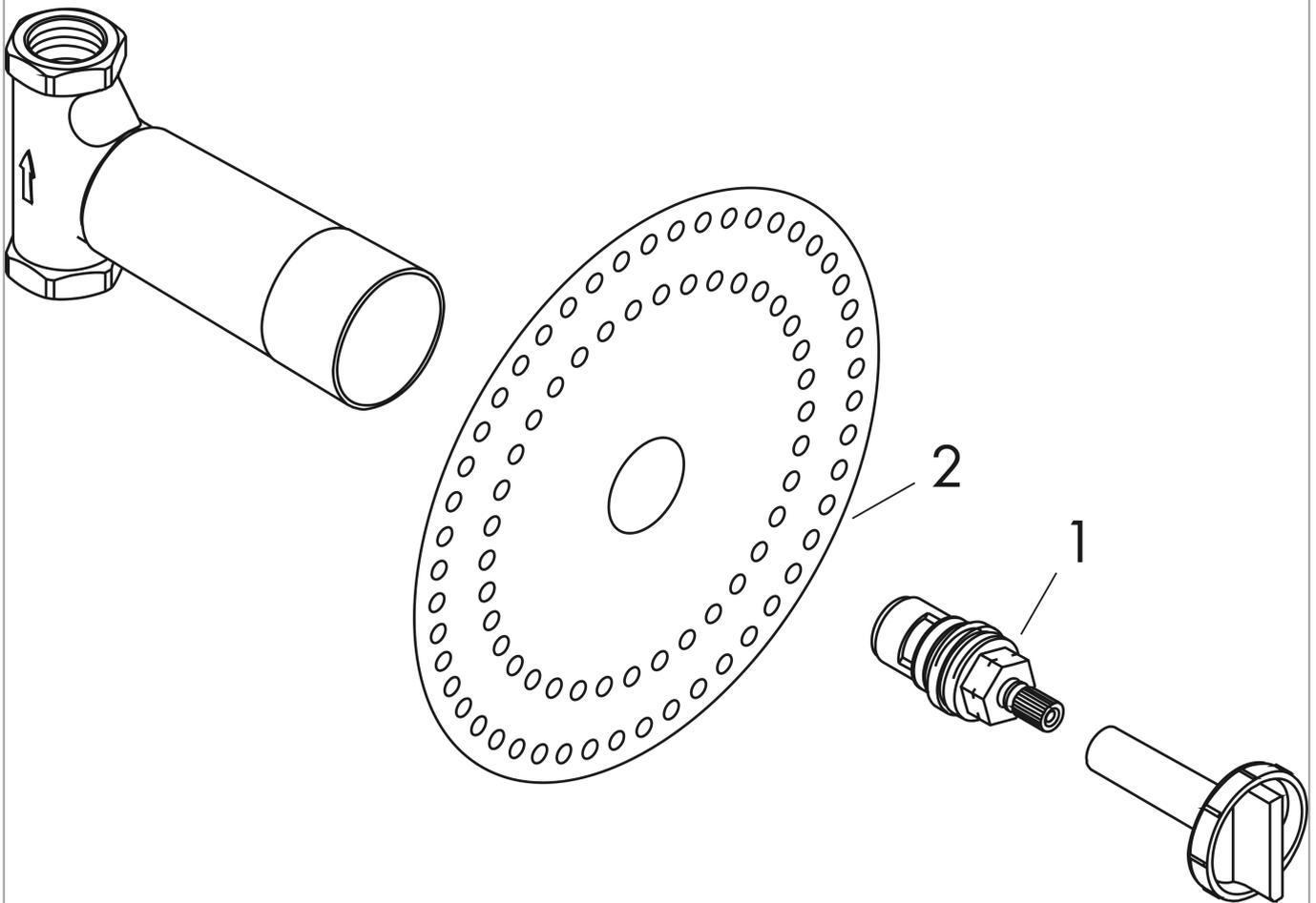
**Grundkörper 52 l/min für Absperrventil 120/120 Unterputz Spindel**
