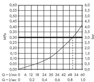
**Grundkörper 52 l/min für Absperrventil 120/120 Unterputz Spindel**
