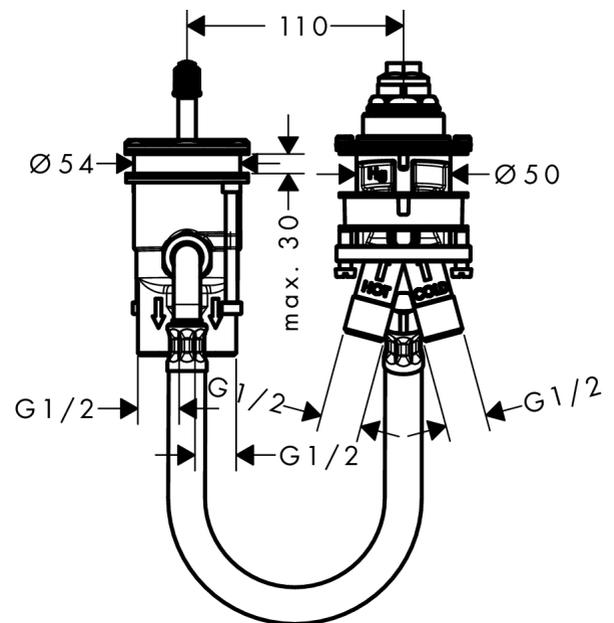
**Grundkörper 2-Loch Wannenrandarmatur für Einhebelmischer**
