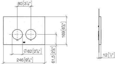
Betätigungsplatte für WC-UP-Spülkasten der Firma Geberit rund - Messing
