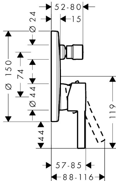
**Zesis S****Einhebel-Wannenmischer Unterputz mit integrierter Sicherungskombination nach EN1717 für
