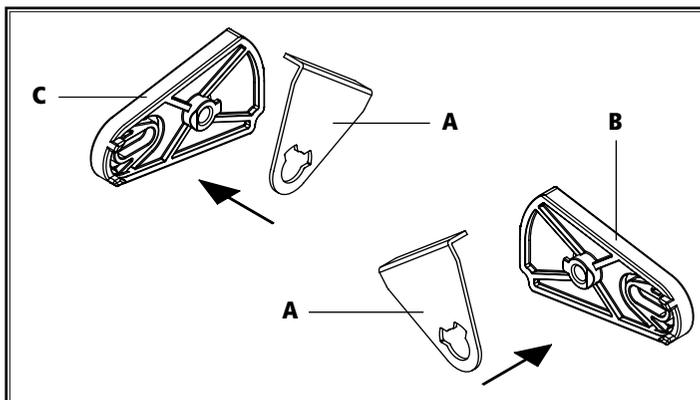
**5 Vormontage Haltetaschen (A) mit Exzenterspanner rechts (B) und Exzenterspanner links (C).**
