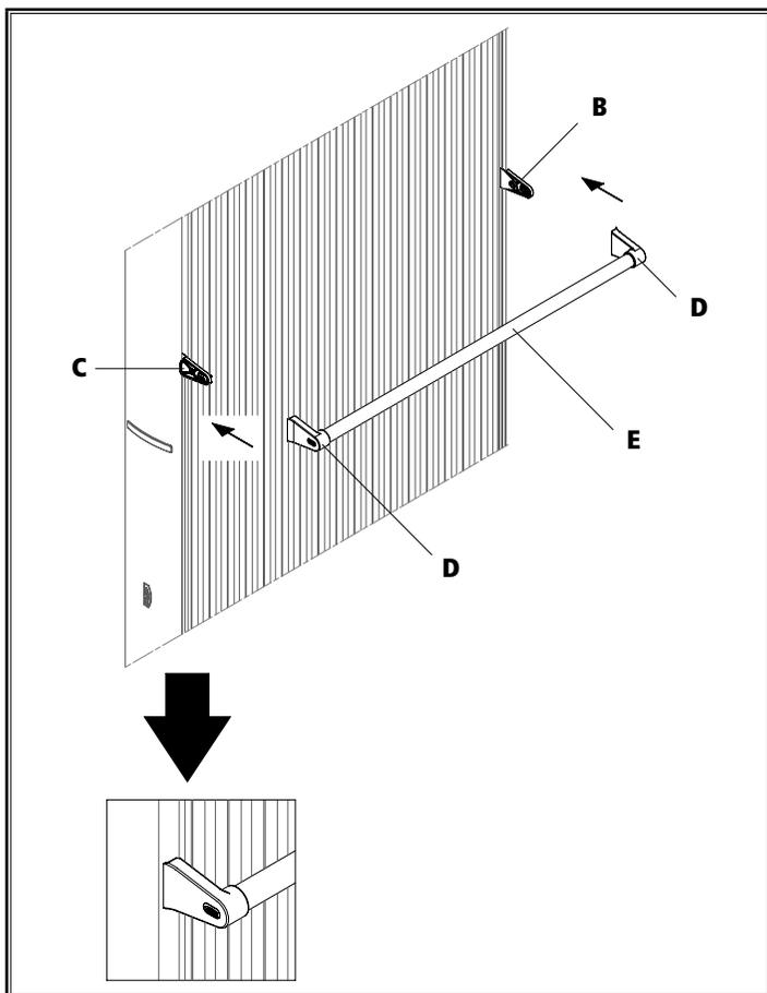
**10 Montagehülsen (D) mit Rohr (E) über jeweiligen Exzenter (B/C) schieben und darauf achten dass beide Montagehülsen (D) einrasten.**
