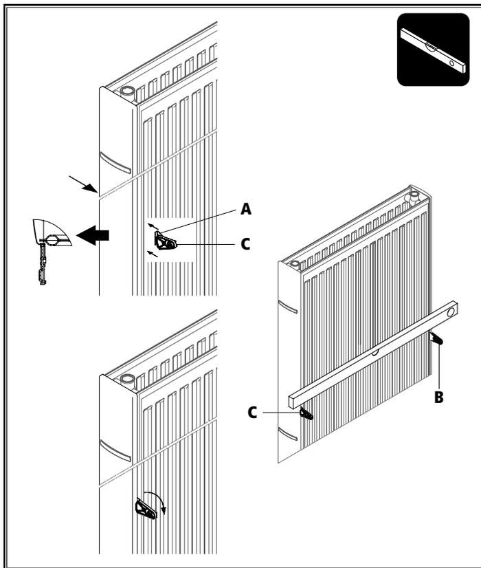
**7 Montage Exzenterspanner (B/C) an senkrechten Heizkörper.**
