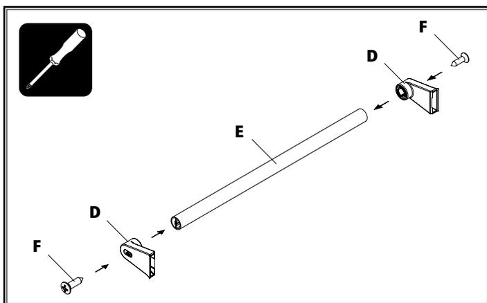
**9 Montagehülse mit Rohr verbinden.**
